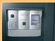
L'entrée de la maison avec reconnaissance d'empreintes digitales. Portier vidéo et dispositif de récupération des paquets et des courses.
